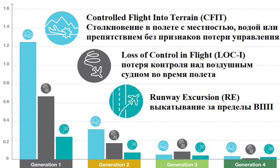
Рисунок 9. Средняя частота катастроф на миллион полетов по поколениям воздушных судов 1958-2023 по категориям причин
