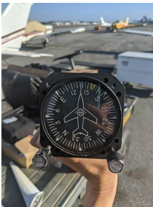
Рисунок 8. Пример авиационного гироскопа
